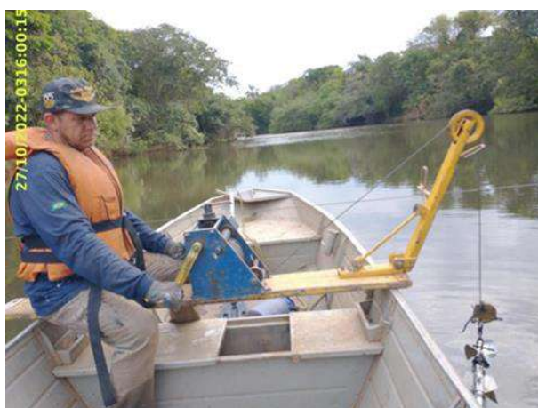
Foto 3 – Medição de descarga líquida no PSED. (Data: 21/10/2022).
