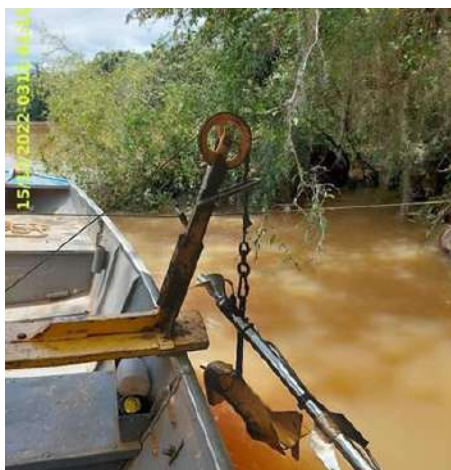
Foto 7 – Medição da descarga líquida no PHM. (Data: 15/12/2022).
