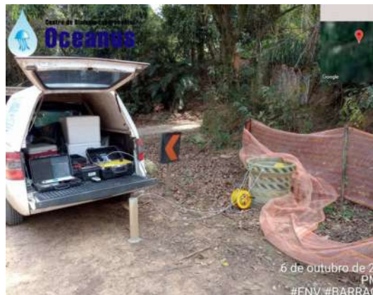
Foto 3. Foto com destaque para a amostragem do poço de monitoramento PM-03.
