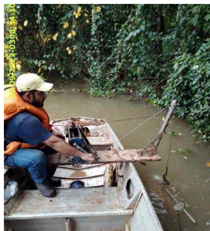
Foto 2 – Amostragem de Sedimento em suspensão no PMH. (Data: 28/09/2022).
