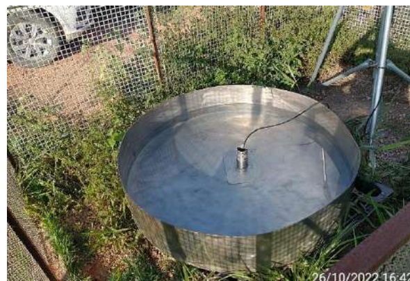
Foto 2 – Tanque do reservatório sendo preenchido com água. (Data: 26/10/2022).
