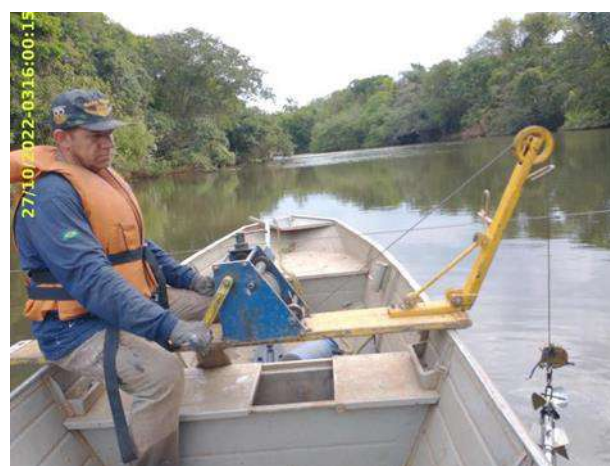
Foto 4 – Amostragem de sedimento em suspensão no PHM. (Data: 27/10/2022).
