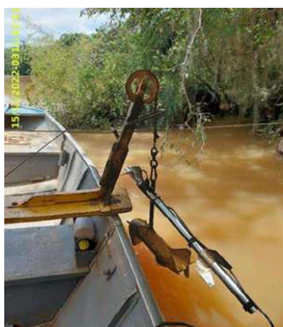
Foto 5 – Medição da descarga líquida no PHM. (Data: 15/012/2022).
